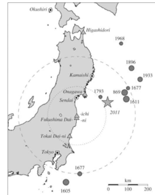
図1 2011年に被災した原子力発電所(三角形)と、東北地方で発生した主な歴史的地震の震源地を示した図(Soloviev & Goの1974年発行のカタログ参照)。東日本大震災は星形、「危険源を考慮しなければならない範囲」として国際基準で定められた福島第一原子力発電所から半径150kmは点線、半径300kmは破線で示している 2 。
